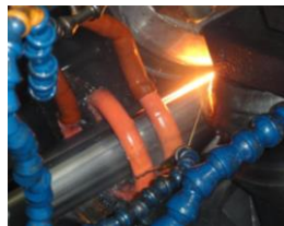
Milling (tube forming, ERW)
